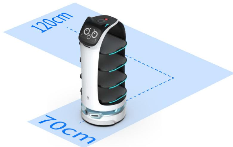
Prémiový senzor s algoritmem SLAM od firmy Pudu umožňuje BellaBotu minimální vzdálenost **70 cm**. Vyhovuje **99 %** scénářům s nezbytným prostorem v průjezdech. Flexibilní a účinný, lze použít ve stísněných prostorech.
