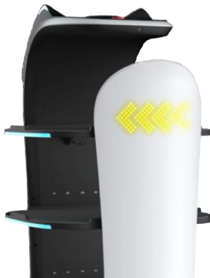
Různé úkoly spouští různé světelné interakce; ouška a ocas BellaBota mohou v reálném čase signalizovat jeho provozní stav a instrukce jsou jasné.
