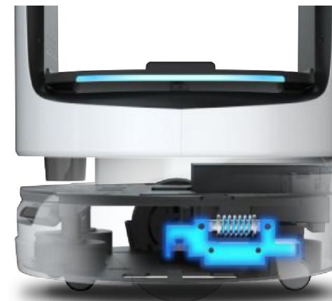
Adaptivní variabilní odpružení s automatickým vyrovnáváním. Tlumiče je možné vyměnit podle různých podlah a jízdních požadavků. Rezonanční frekvence je udržována v optimálním stavu. Dokáže překonávat překážky s výškou **1 cm**. Bezpečné doručování pokrmů. Jízdní stabilita se zlepšila o **50 %**.
