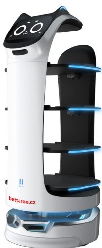
BellaBot – doručovací robot, vhodný do větších prostor, například restaurací
