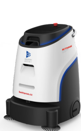
ECOBOT Vacuum 40 – vysávací robot vhodný do prostor až 1 200 m 2
