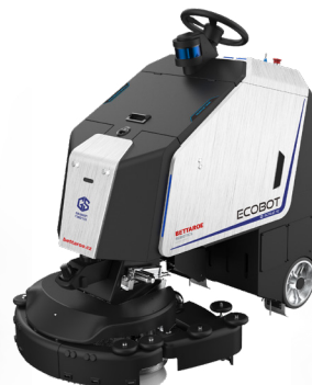
ECOBOT Scrubber 75 – první mycí robot, určený pro špatně čistitelné plochy až do 3 000 m 2
